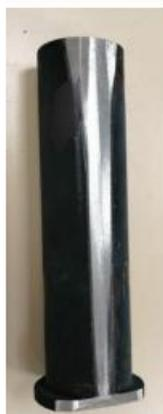
Figure 3 : Eprouvette jominy polie avant la dureté
