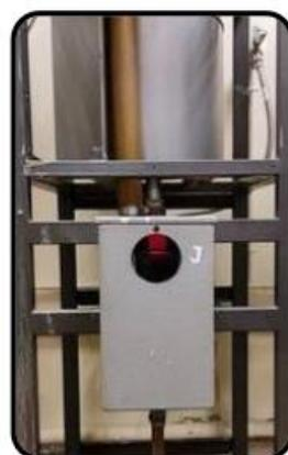
Figure 2 : Système de refroidissement de l'éprouvette
